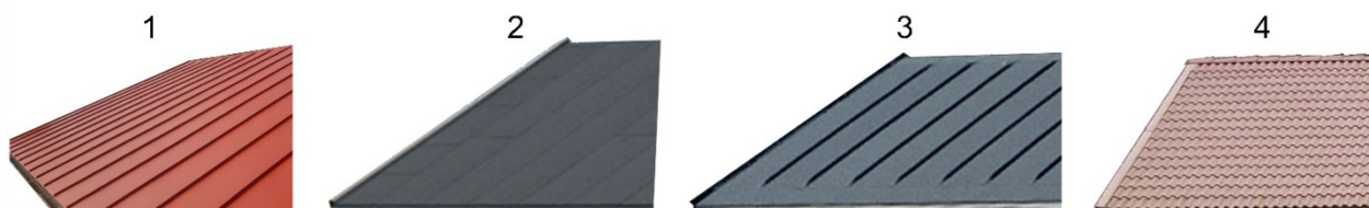
Kuva 35. Alueella käytettäviä katemateriaaleja: 1 konesaumattu pelti / pystysauma-/lukkosaumakatteet, 2 bitumikermi, 3 kolmiorimakate (bitumikermikate) ja 4 savi-/betonitiilikate. Katteen väri vaihtoehdot ovat musta, punainen, savitiilenpunainen, harmaa, tummanharmaa, ruskea ja tummanruskea.
