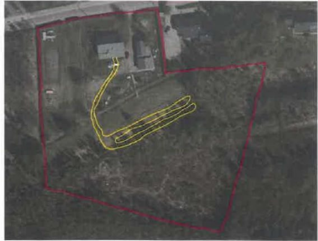
Kuva 7. Kiinteistön maalämpöjärjestelmän lämmönkeräysputkien likimääräinen sijainti ilmavalokuvaan piirrettynä.
