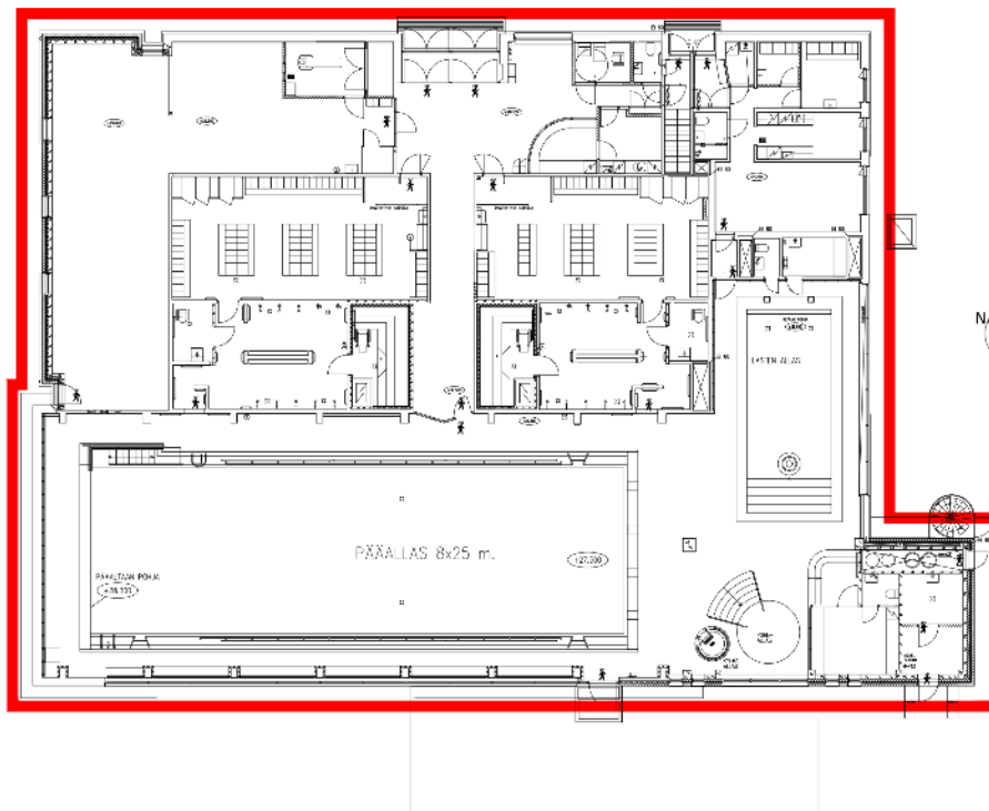
Kuva 3. Uimahallin pohjakuva 1. kerros (Arkkitehtuuritoimisto Ossi Rajala 1971)
