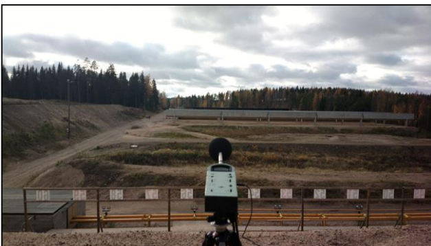
Kuvat 1. Näkymiä lähimittauksista ja radoista. (ylä) Uusi vaimennettu katos radalla 2 sivuvalleineen ja yläkulisseineen. (2. ylhäältä, vasen) Kulisseja mitattiin osaksi vertailemalla katoksesta ja avoimelta tieltä ammuttujen laukausten äänitasoja taustavallilla ja sen takana mäenrinteessä. (2. ylhäältä, oikea) Katosten ja kulissien vaikutusta mitattiin myös takasuunnissa. (2. alhaalta) Radalla 5 on sekä vaimennetut kulissit, korkea sivuvali että katoksessa jatkettut etuseinäkkeet. (ala) Kuvia mittauksista, joilla selvitettiin kulissien vaikutusta melun leviämiseen.
