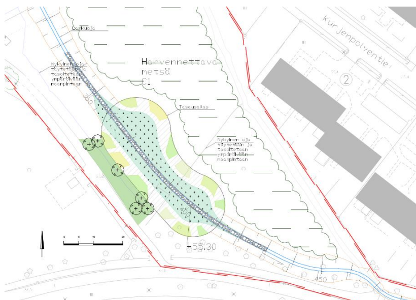
Kuva 31. Ote Riihipuistoon suunnitella olevan tasausaltaan suunnitelmasta (yleisen alueen suunnitelma, nähtävillä 13.2 - 27.2.2019). Suunnitelmassa on osoitettu myös tasausaltaseen laskeva laskuoja.
