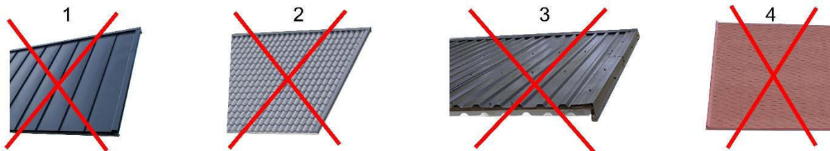
Kuva 14. Katemateriaalit, joita ei suositella: 1 pystysauma-/lukkosaumakatteen, 2 teräsprofiilikatteen, 3 profiilipeltikatteen ja 4 palahuopakatteen.
