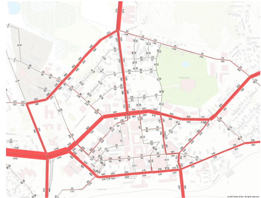
Liikennemäärät iltahuipputuntina 2030. Henkilöautoliikenteen toimivuus pääkaduilla on pääosin kohtuullinen tai vähintään tyydyttävä iltaruuhkan 2030 liikenne-ennusteella.
