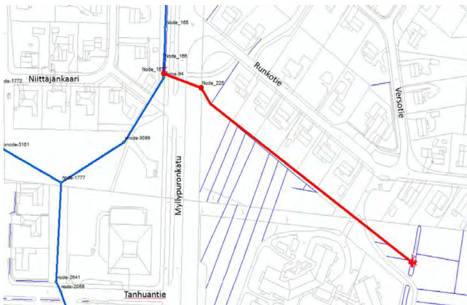
Kuva 20 Uusi Myllypuronkadun alittava purkureitti
