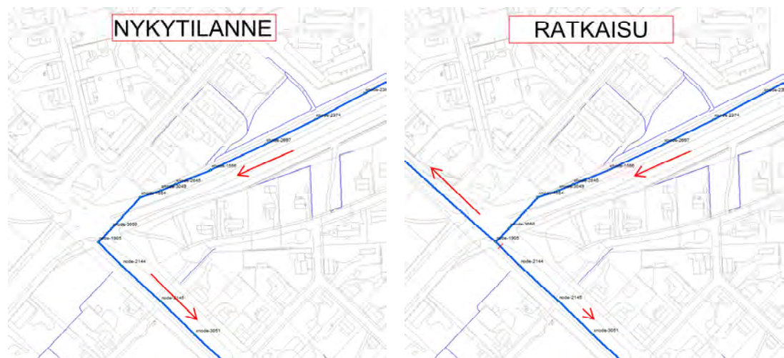
Kuva 22 Hulevesien uusi reititys Palomäenkadun ja Karjalankadun risteysalueella
