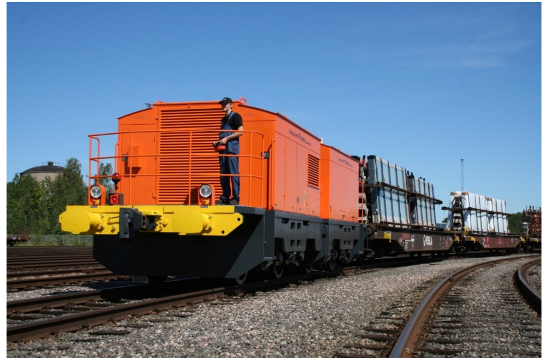
Suomalainen 100 tonnin painoinen robottiveturi, joka koostuu kahdesta kaksiakselisestä 50 tonnin moduulista.
