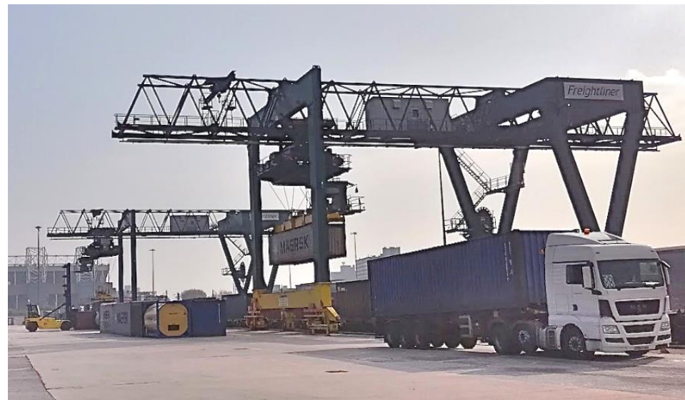
Kiskoilla kulkeva raskas pukkinosturi eli RMG . Näiden kahden RMG-nosturin investointi oli yhteensä 4 milj. puntaa (Manchester, 2009).
