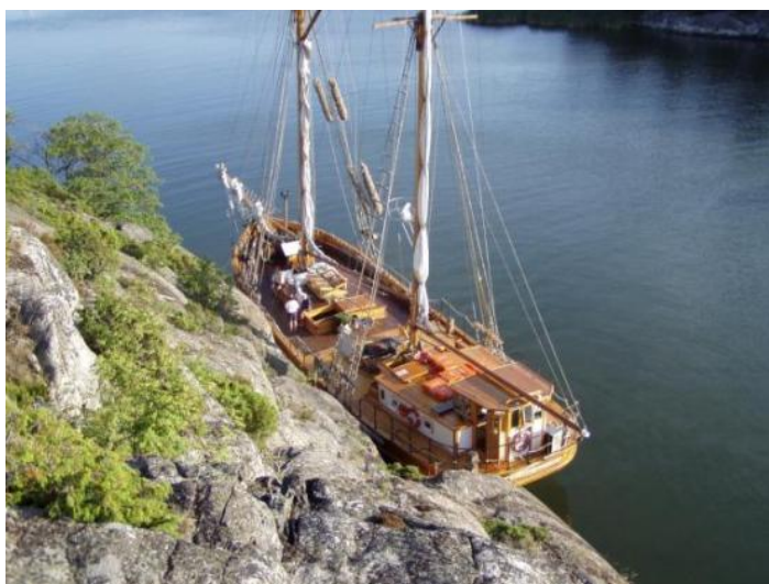
Hiekkajaala Astrid toimii nykyisin risteilyaluksena. Se rakennettiin Våloxissa 1947 ja toimi rahtialuksena vuoteen 1969. Pituus 25, leveys 7,1, syväys 2,2 metriä. Konetehto 330 hv
